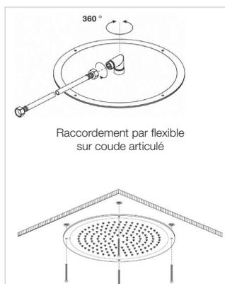
Raccordement par flexible
